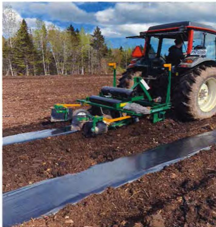
**Pose du paillis et déroulement de la conduite secondaire**
